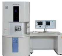
日立ハイテクノロジーの 集束イオン/電子ビーム 加工観察装置
